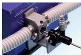
Staubschutz mit Druckluft beim Einsatz in staubhaltigen Räumen.
