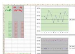
PC - Software GageXcom für die Programmierung des Sensors und Aufnahme der Messwerte über Excel (\*) - Tabellen.
